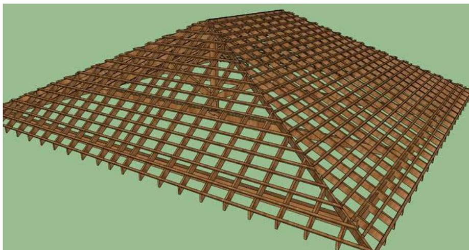
A nova cobertura permanecerá com a mesma quantidade de águas do telhado anterior, quatro águas e deverá contemplar tesouras, pilares, vigas, terças, caibros e ripas, incluindo tratamento com cupinicida.
