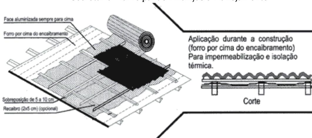
A telha a ser instalada deve ser do tipo capa/canal, com inclinação de 35 %.
