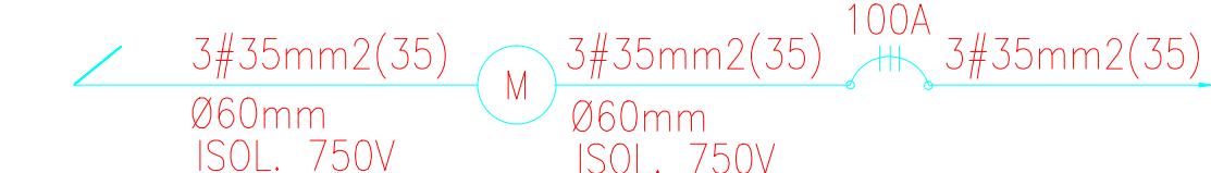
DIAGRAMA UNIFILAR GERAL
